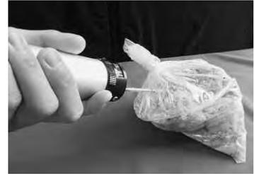
図3：北側式検知管によるNH<sub>3</sub>計測
