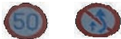
図 12 提案手法 1 により抽出された標識内部領域 Fig. 12 Extracted sign inner area by first proposal method.
