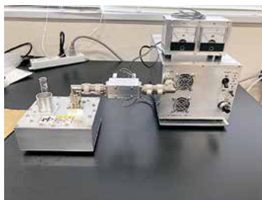
図2 半導体式マイクロ波照射機 （HPA-100W STD System、クロニクス）
