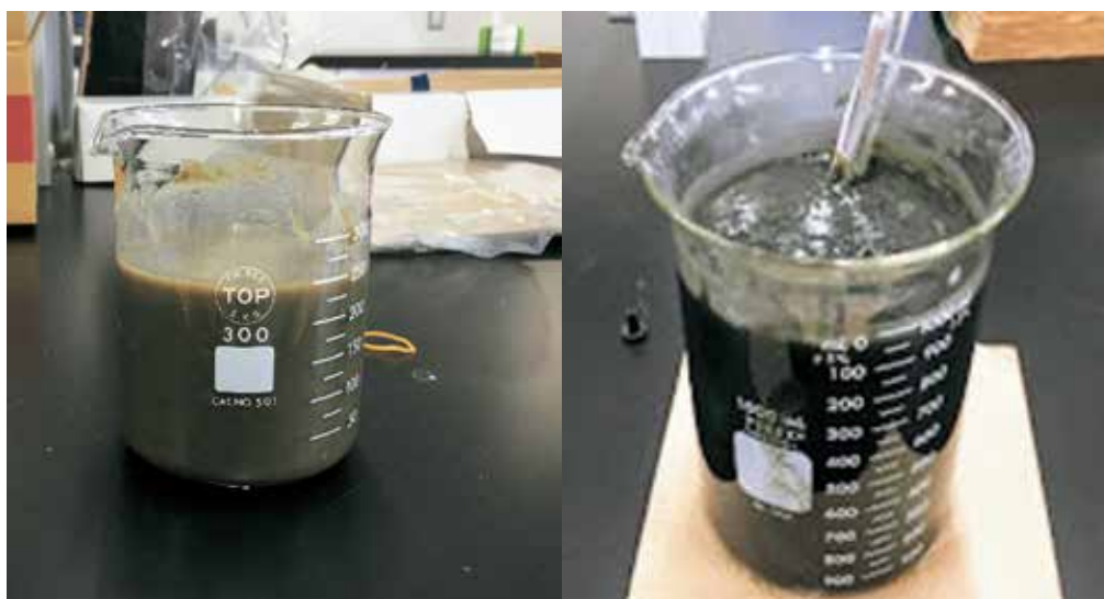
図3 実験に用いた下水汚泥（左：余剰汚泥、右：消化汚泥）
