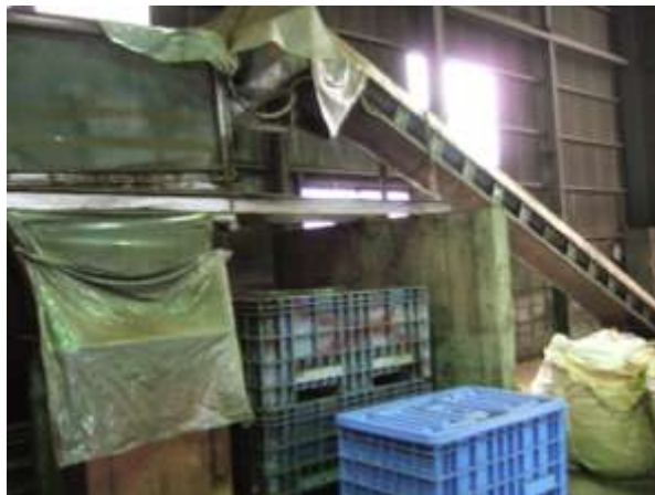
写真 5-10 ドラム回転式ふるい選別機
